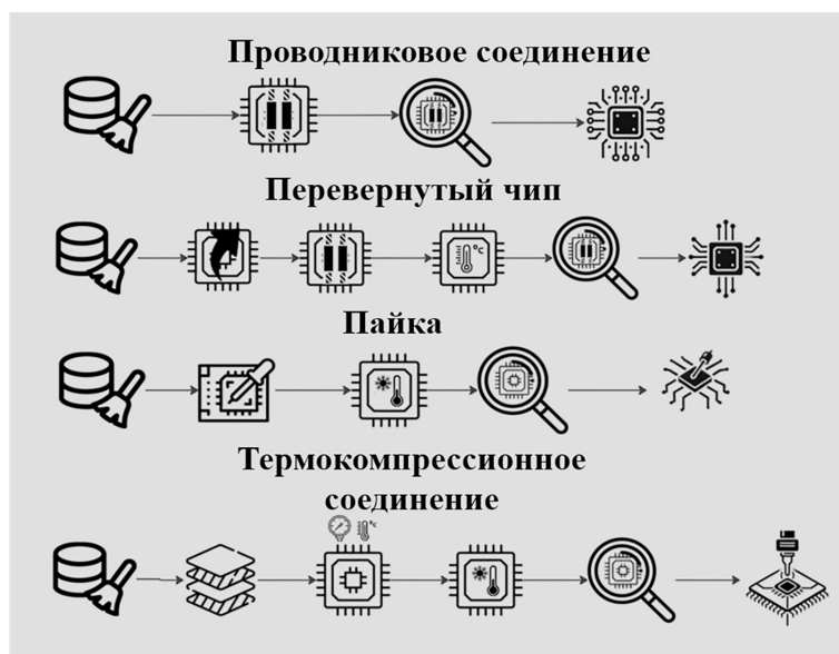
Рис. 2. Основные методы монтажа кристаллов:
