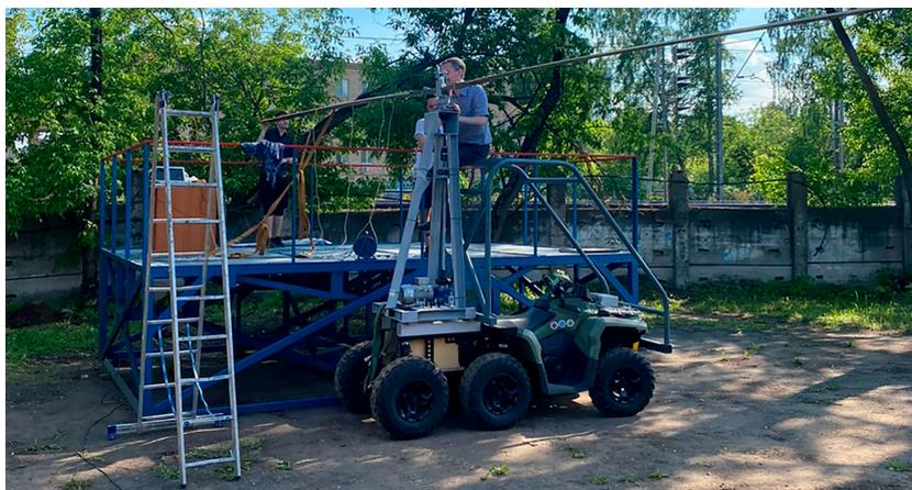
Рис. 1. Жесткостные испытания несущего винта специализированного стенда
