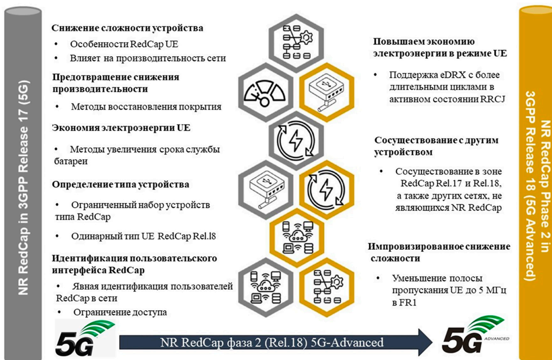
Рис. 2. Эволюция NR RedCap в последних версиях Rel.17 и Rel.18.
