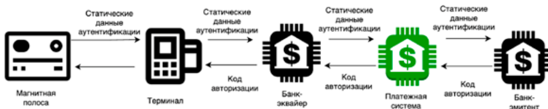
Рис. 2. Схема авторизации транзакции картой с магнитной полосой
