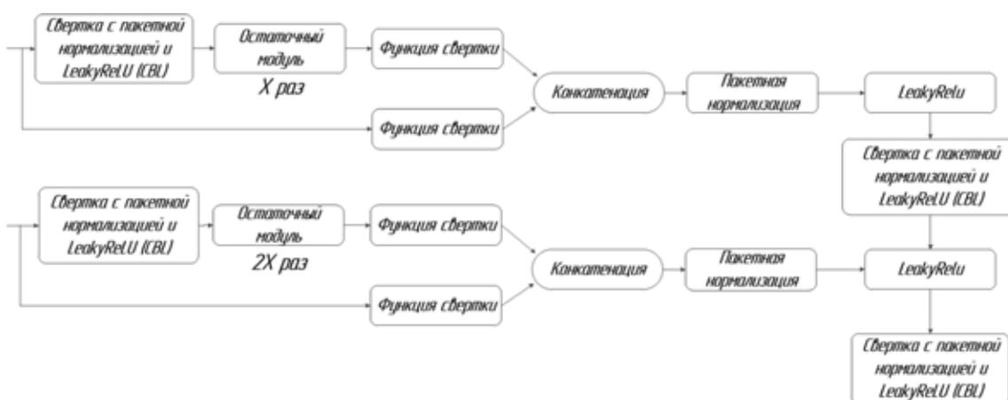
Рис. 5. (а) Многоступенчатая частичная сеть (CSP – Cross Stage Partial Network) 1\_X,
