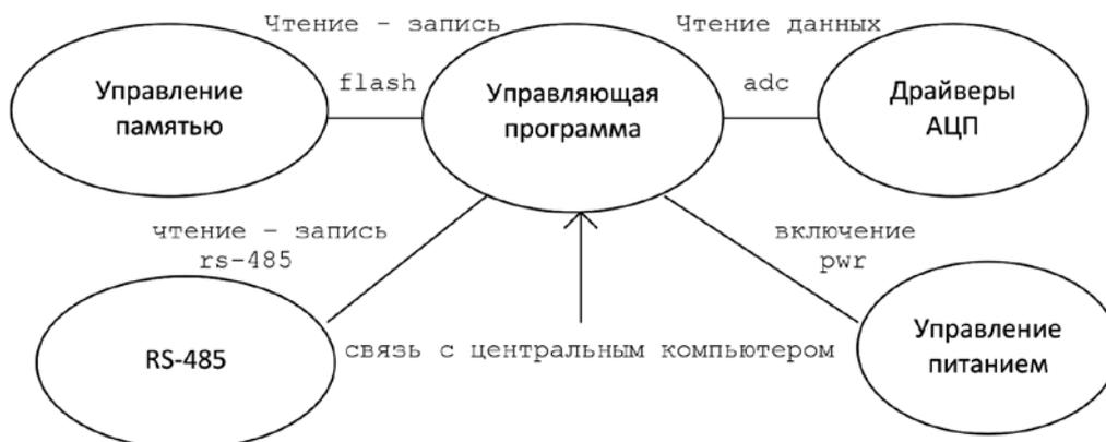
*Структурная схема программного обеспечения*
