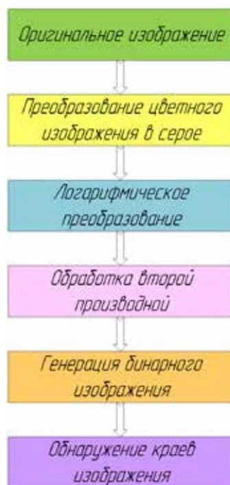
Рис. 2. Этапы предварительной обработки
