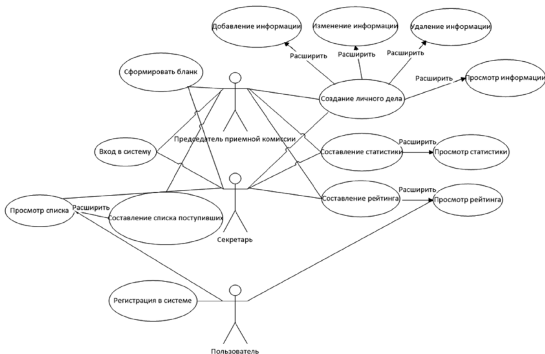
Рис. 3. Варианты использования разрабатываемой системы
