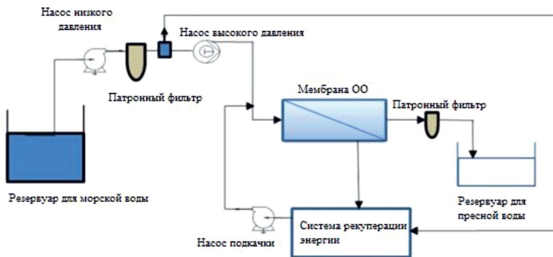
Рис. 1. Схема опреснительной установки обратного осмоса с использованием системы рекуперации энергии
