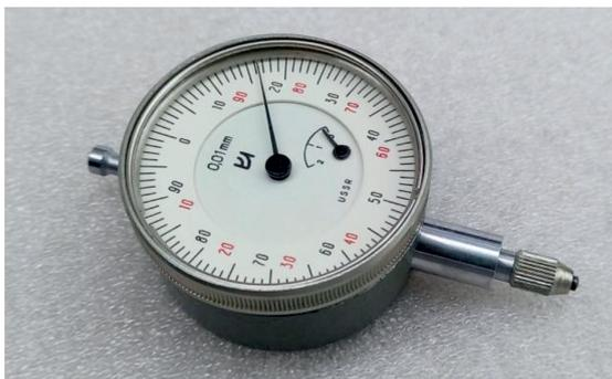
Рис. 1. Индикатор часового типа
