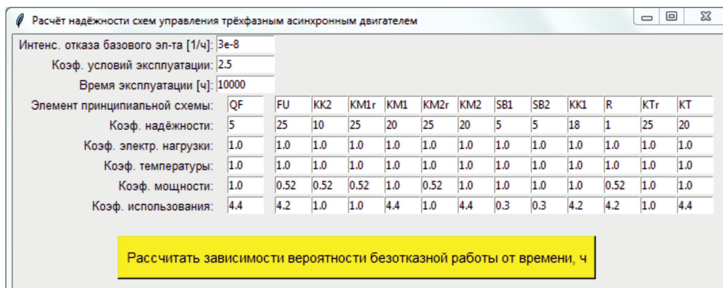
Рис. 2. Интерфейс программы расчёта надёжности схем управления трёхфазным асинхронным двигателем
