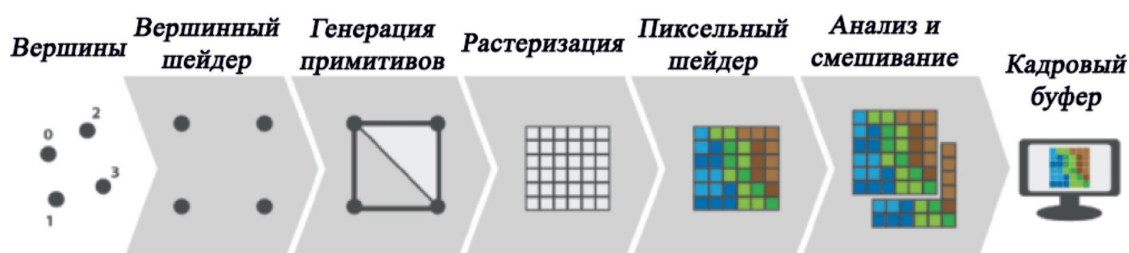
Рис. 2. Конвейер рендеринга OpenGL 2.0
