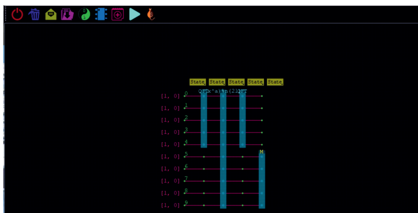
Рис. 11. Реализация схемы алгоритма Шора в эмуляторе Q-Kit
