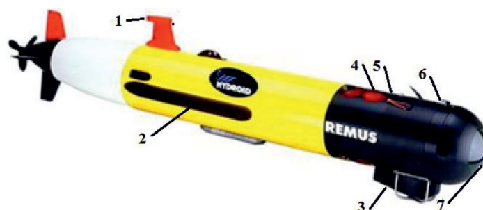
Рис. 2. АНПА REMUS 100, модифицированный для док-станции
