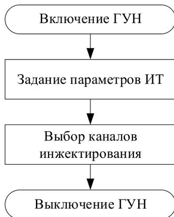
Рис. 2. Блок-схема работы блока инжектирования
