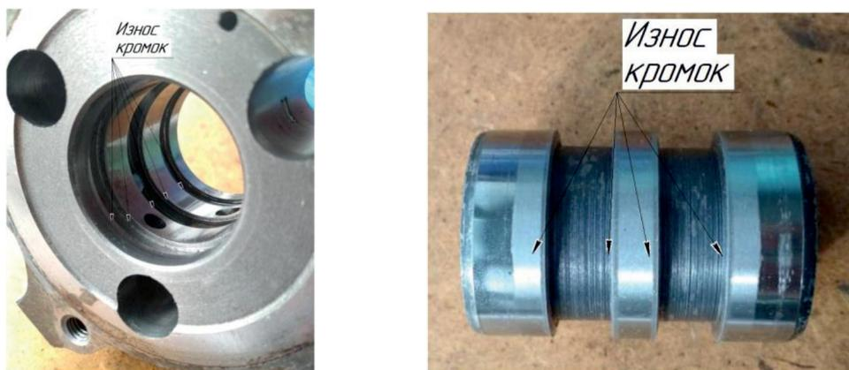
Рис. 1. Места износов поясков корпуса и золотника
