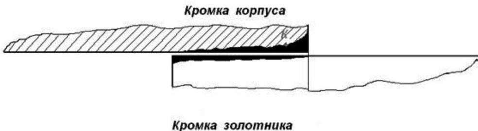
Рис. 5. Форма изношенных кромок золотника и корпуса распределителя
