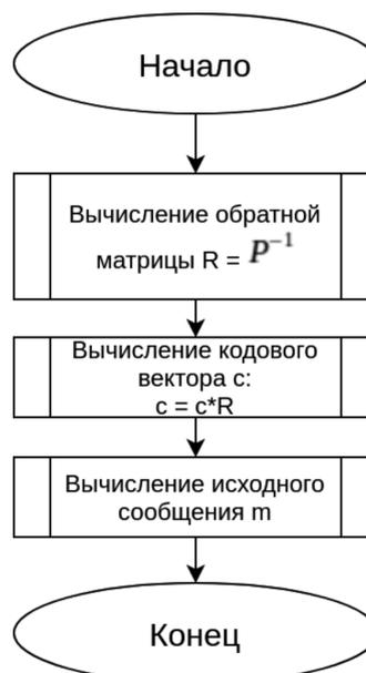
Рис. 3. Блок-схема алгоритма расшифровывания сообщения криптосистемы Мак-Элиса
