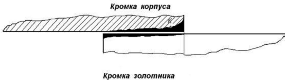
Рис. 5. Форма изношенных кромок золотника и корпуса распределителя
