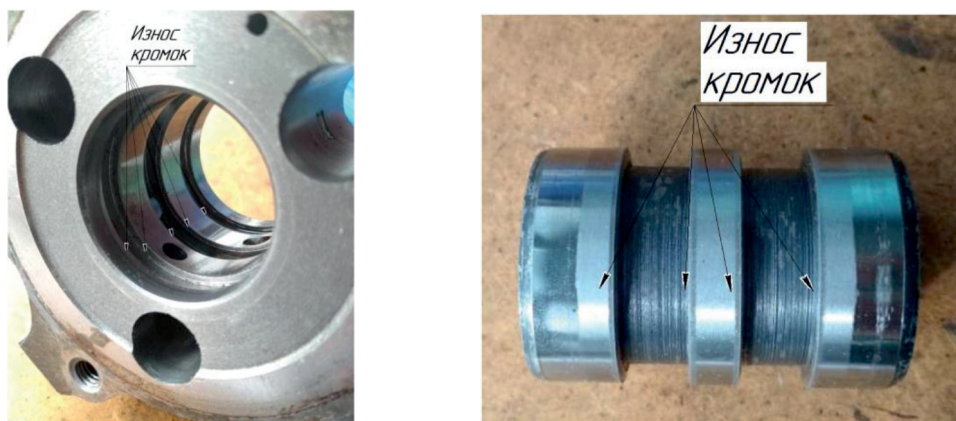
Рис. 1. Места износов поясков корпуса и золотника
