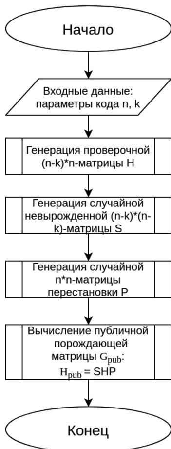
Рис. 4. Блок-схема алгоритма генерации ключей криптосистемы Нидеррайтера
