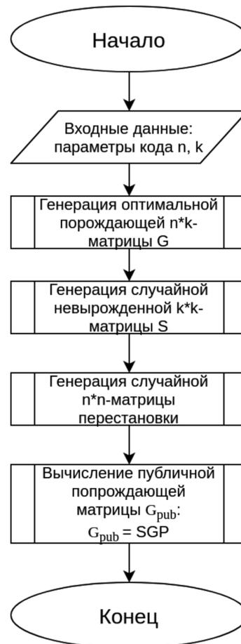
Рис. 1. Блок-схема алгоритма генерации ключей криптосистемы Мак-Элиса
