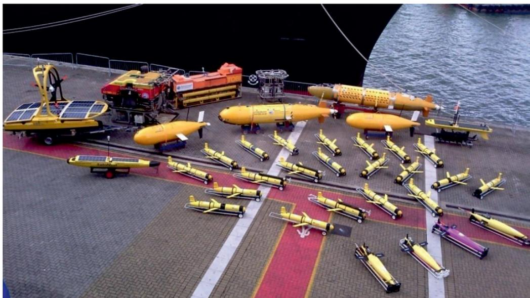
Рис. 1. Средства робототехники для океанологических исследований на причале около научного судна Национального океанографического центра Великобритании
