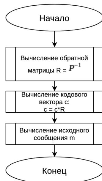
Рис. 3. Блок-схема алгоритма расшифровывания сообщения криптосистемы Мак-Элиса
