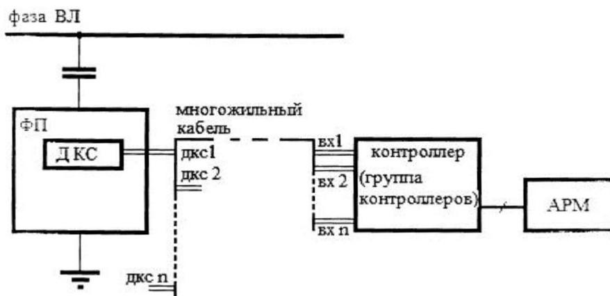
Рис. 4. Структурная схема системы контроля состояния конденсатора связи с использованием датчика контроля конденсатора связи
