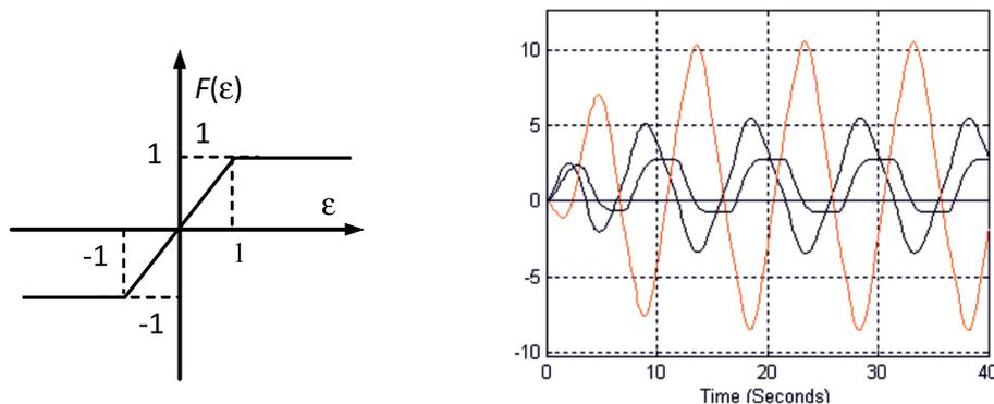
Рис. 5. Вид нелинейности и переходные процессы при  $k = 1$
