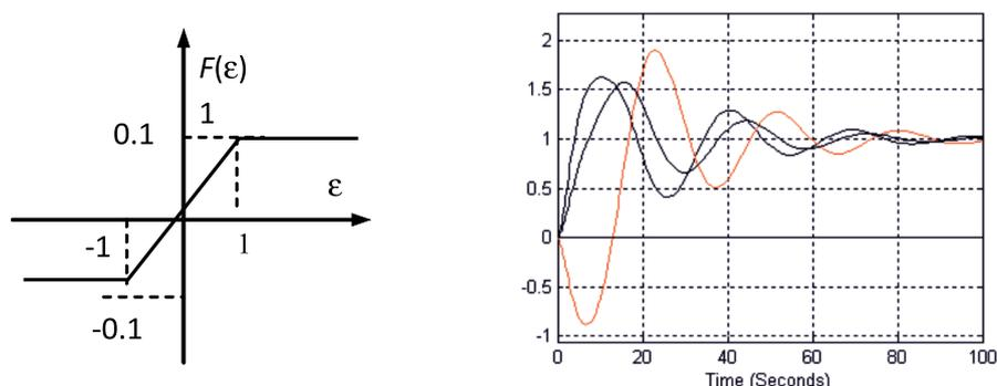
Рис. 6. Вид нелинейности и переходные процессы при  $k = 0,1$
