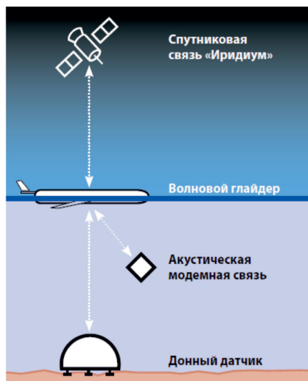
Рис. 4. Использование беспилотника «Wave Glider» по сейсмической программе: схема барражирования глайдера над сейсмографом (слева) и расширение глобальной зоны покрытия (справа)
