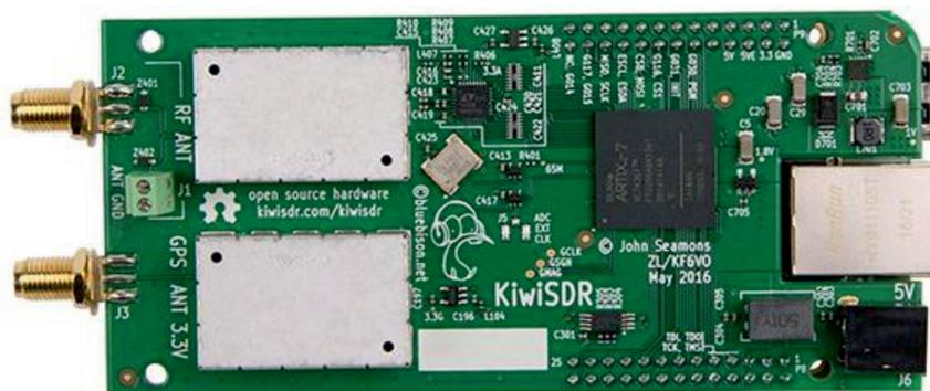
Рис. 4. Плата радиоприемника SDR KiwiSDR
