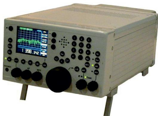
Рис. 2. Внешний вид радиоприемного устройства типа «Галактика-М2»
