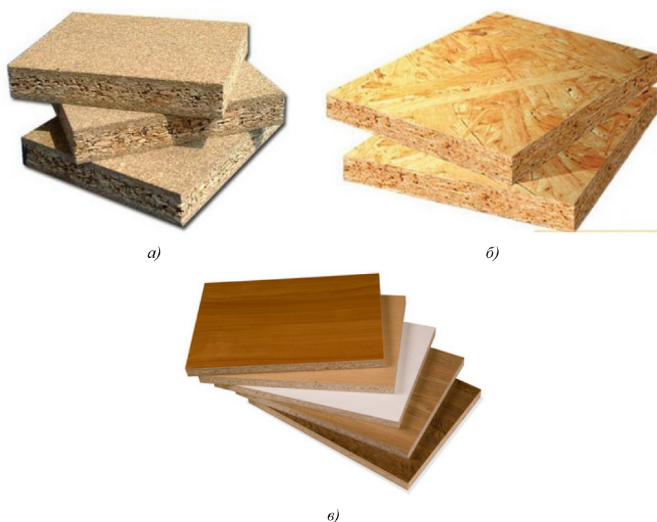
Рис. 13. Разновидности древеснослоистых пластиков: а – древесностружечная плита (ДСпП); б – древесноволокнистая плита (ДВП); в – ламинированный древеснослоистый пластик (ЛДСП)
