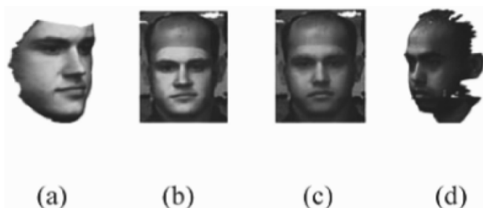
Рис. 2. Иллюстрация лицевой реконструкции методом морфинга: a – лицевая часть 3D-шаблона; b – трехмерный шаблон, наложенный на двумерное изображение лица; c – промежуточная стадия морфинга 3D-шаблона; d – реконструированная трехмерная модель лица
