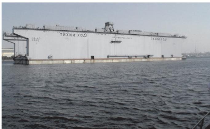
Рис. 5. Ремонтный композитный плавучий док
