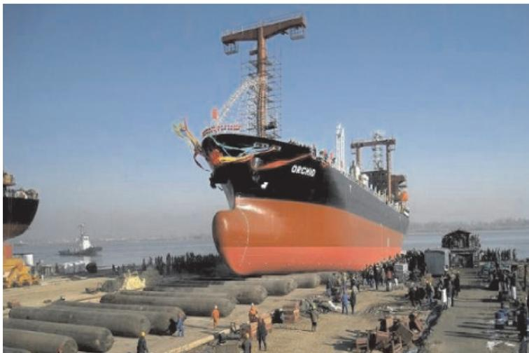
Рис. 3. Спуск судна на пневматических баллонах
