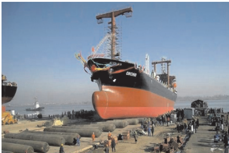
Рис. 3. Спуск судна на пневматических баллонах
