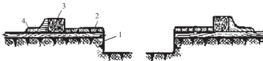
Рис. 1. Схема поперечного сечения продольного наклонного стапеля: 1 – железобетонное основание стапеля; 2 – спусковые дорожки; 3 – рыбина; 4 – крепление рыбины
